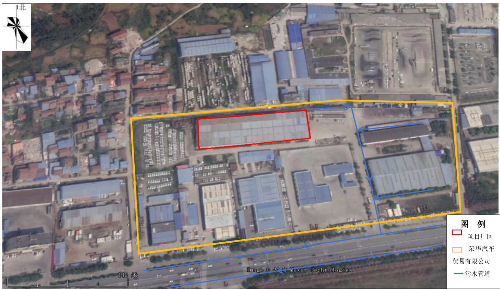
附图 5 项目所在厂区污水管网示意图
